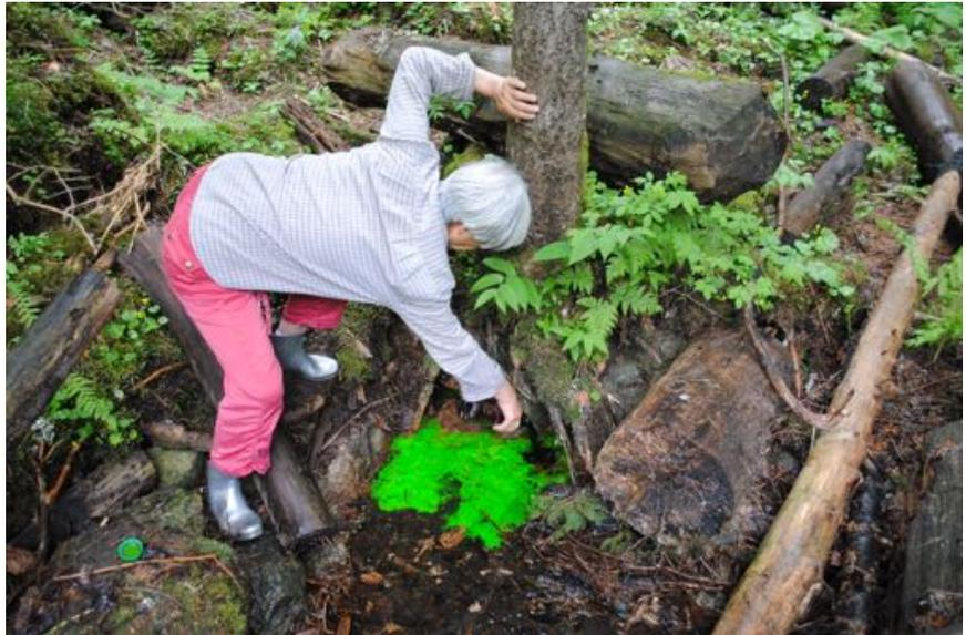
Le traceur fut détecté 13 h plus tard à S2, avec un pic à 17 ppb 27 h après l'injection, comme on peut le constater à la fig. 7.
