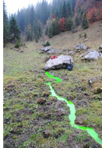
Aucune perte n'avait pu être localisée, bien que de l'eau s'y accumule lors de précipitations abondantes. 150 gr. de fluorescéine diluée y furent déversés (fig. 9).
