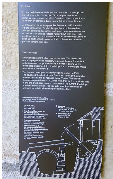
Fonctionnement du pont-levis à contrepoids
